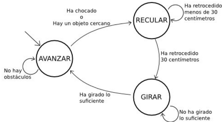
Figura 1.11: Ejemplo de autómata que define el comportamiento de un robot.
