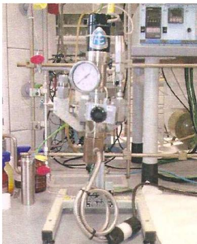
**Figura 11.** Reactor autoclave utilizado en la formación de biodiésel
