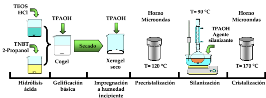
Figura 4.1. Esquema de la síntesis de materiales zeolíticos tipo TS-1 con porosidad jerarquizada a partir de geles líquidos. [I. Moreno, 2009].
