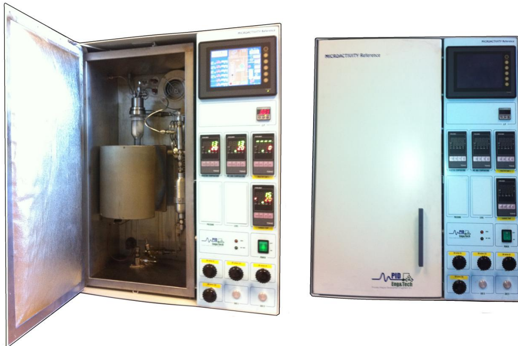
Figura 3.3.1: Fotografías de la instalación de reacción empleada para la DCM.
