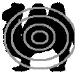
Figura 4.3: representación de las circunferencias que se trazan sobre una imagen para conocer la propiedad de circularidad de la imagen
