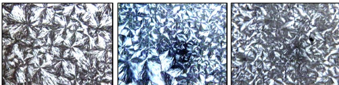
Figura 4.89: Polímeros sin nuclear cristalizados a 125 °C con objetivo 12.5x, 1mm=15 \mu m. Izquierda: PRE4.8; Centro: PRB5.0; Derecha: PRE1.5B3.0.
