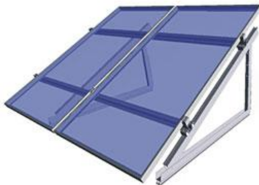
Figura 12. Estructura soporte de los paneles propuesta.
