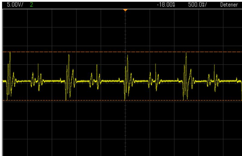
Gráfica 7. Variación de la tensión con el tiempo para la toma de datos "en vacío" en el ciclo de vibración "e"
