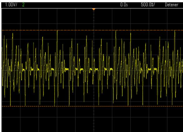
Gráfica 18. Variación de la tensión con el tiempo para la toma de datos "con carga" de 470  $\Omega$  en el ciclo de vibración "b"
