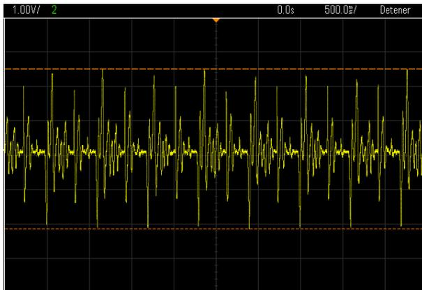
Gráfica 17. Variación de la tensión con el tiempo para la toma de datos "con carga" de 470 Ω en el ciclo de vibración "c"
