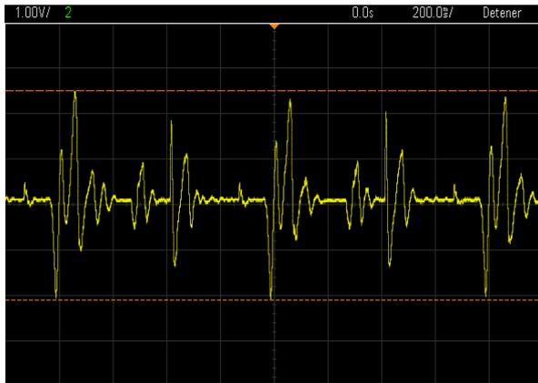
Gráfica 14. Variación de la tensión con el tiempo para la toma de datos "con carga" de 470 Ω en el ciclo de vibración "e"
