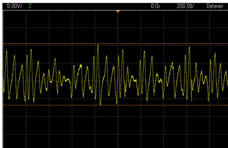
Gráfica 11. Variación de la tensión con el tiempo para la toma de datos "en vacío" en el ciclo de vibración "a"
