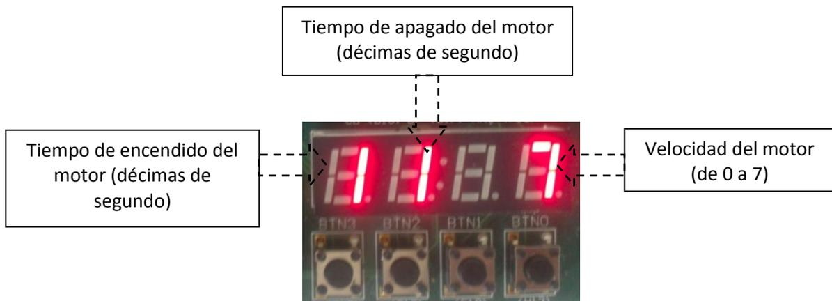
Imagen 2. Ejemplo de configuración en la placa FPGA
