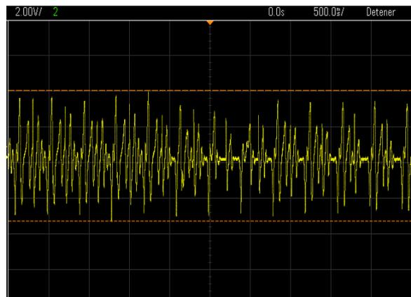
Gráfica 19. Variación de la tensión con el tiempo para la toma de datos "con carga" de 1 k $\Omega$  en el ciclo de vibración
