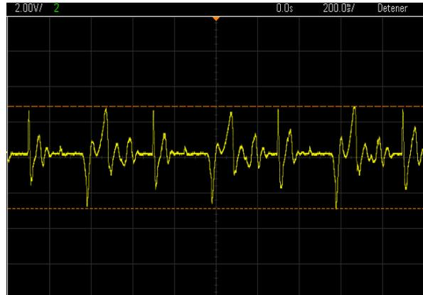
Gráfica 16. Variación de la tensión con el tiempo para la toma de datos "con carga" de 1 kΩ en el ciclo de vibración "c"
