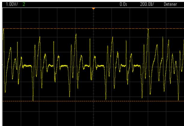
Gráfica 15. Variación de la tensión con el tiempo para la toma de datos "con carga" de 1 kΩ en el ciclo de vibración "d"
