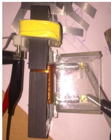
Imagen 12. Montaje para determinar el número de vueltas de la bobina empleada en el diseño
