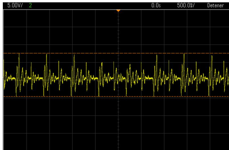
Gráfica 9. Variación de la tensión con el tiempo para la toma de datos "en vacío" en el ciclo de vibración "c"
