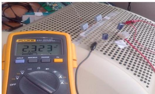
Figura 29. Resultado de voltaje al acercar el sistema a una fuente emisora de radiofrecuencia
