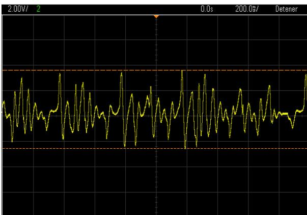
Gráfica 20. Variación de la tensión con el tiempo para la toma de datos "con carga" de 470  $\Omega$  en el ciclo de vibración
