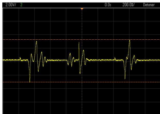
Gráfica 13. Variación de la tensión con el tiempo para la toma de datos "con carga" de 1 k $\Omega$  en el ciclo de vibración "e"
