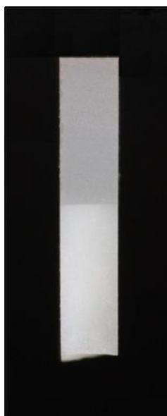
Imagen 3.2: Detalle de un espécimen con forma de barra, listo para ser sometido a la prueba de microtracción. Obsérvese la adecuada horizontalidad de la interfase adhesiva.
