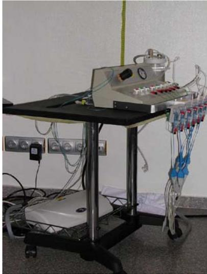
2. Bomba de perfusión hidroneumocapilar. Consiste en una Bomba de Perfusión en 8 canales, de baja compliance para Manometría, con capilares. Mantiene una perfusión continua de agua a alta presión en el extremo distal de los canales de unos 0,5 ml/min.
