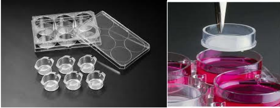
Figura 12. Placa de 6 pocillos con sus correspondientes inserts . Extracción del insert de la placa tras el cultivo
