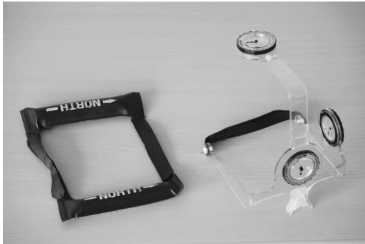
Figura 3. Aparato CROM, para medir los rangos de movimiento cervical.
