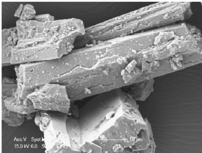
**Figura 4.97. Micrografías obtenidas mediante SEM de una incrustación real.**
