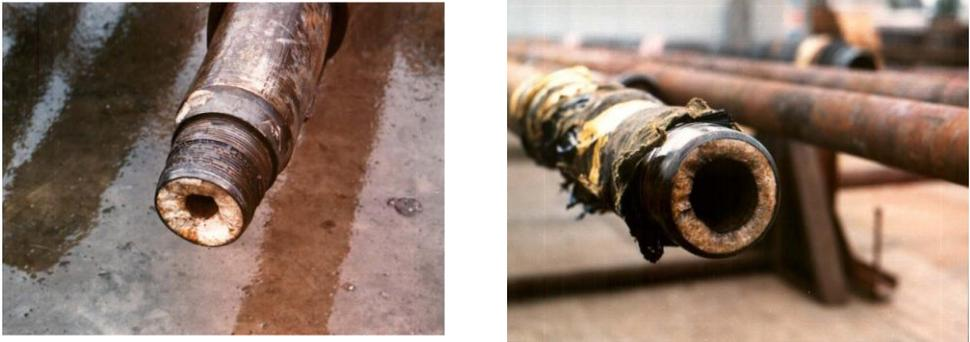
Figura 2.6. Tuberías con incrustaciones inorgánicas [22]
