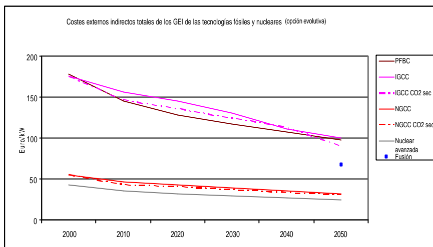
Figura 29. Costes externos indirectos totales de las tecnologías fósiles y nucleares en €/kW, opción evolutiva
