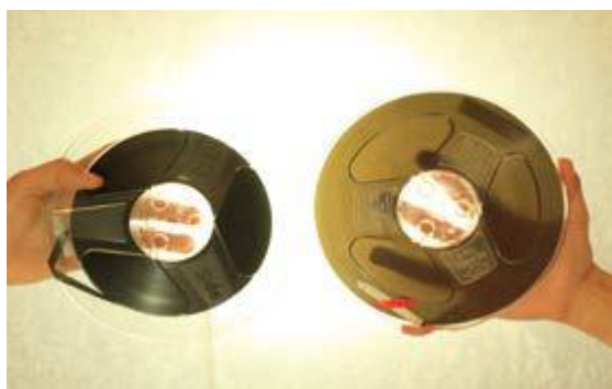
Figura 7. Imagen de dos cintas magnéticas, a la derecha de acetato y a la izquierda de poliéster. Fuente: ARSC (2015: 26). 18
