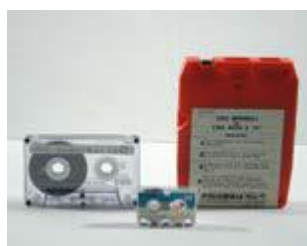
Figura 8. Imagen de casete, microcasete y cartucho de 8 pistas. Fuente: ARSC (2015: 25).
