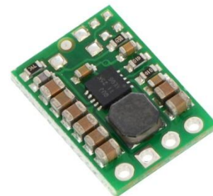
Figura 46: Imagen del regulador S7V8F5 [92].
