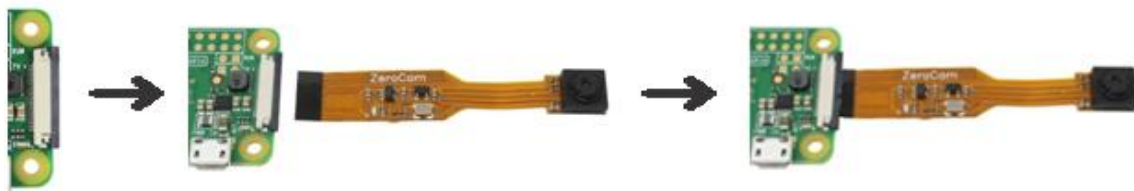
Figura 12: Proceso de conexión de la cámara a la Raspberry.
