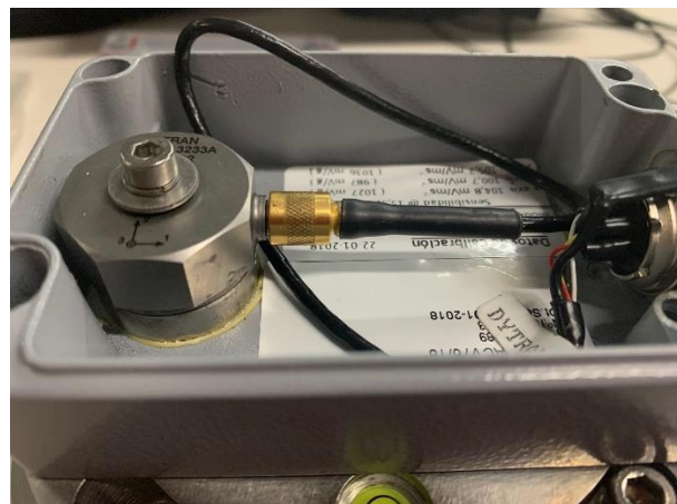
Figura 21: Datos de la sensibilidad del acelerómetro y acelerómetro.
