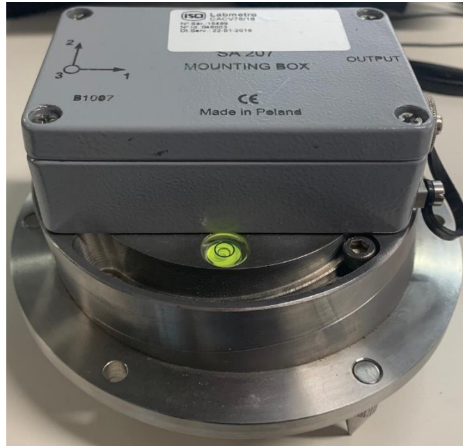
Figura 22: Masa sísmica dónde se encuentra el acelerómetro.
