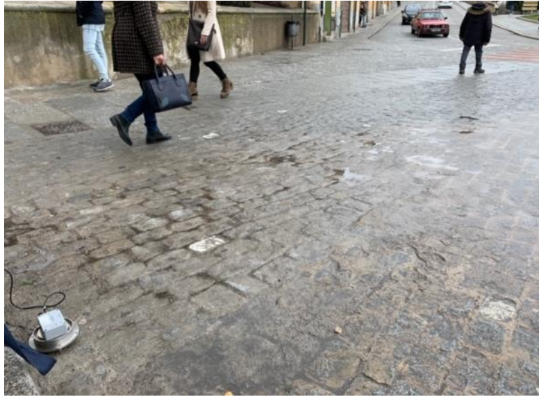
Figura 25: Colocación acelerómetro en la Plaza de Artillería.
