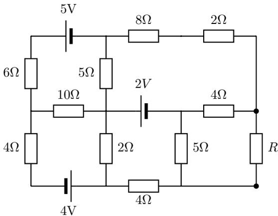
20. Calcular el valor de la resistencia  $R$  que maximice la potencia disipada en ella.
