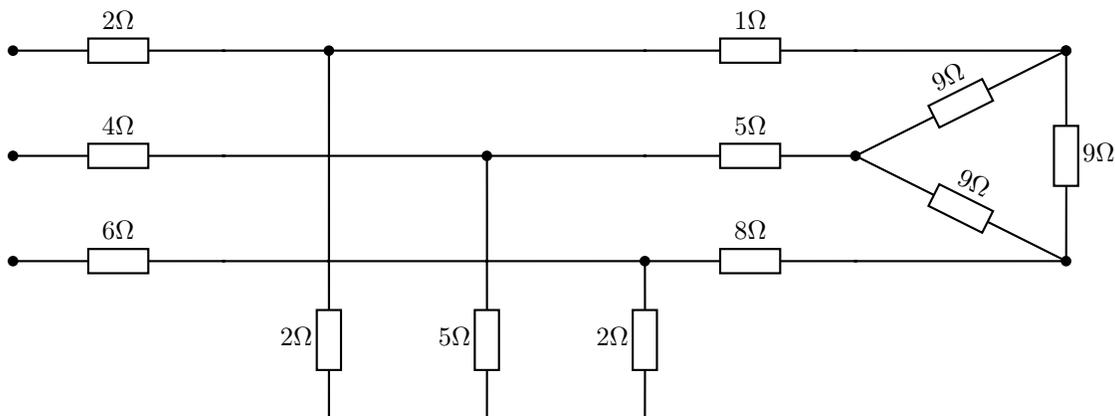
6. Reducir el circuito de la figura siguiente con fin de obtener un equivalente en triángulo de la carga.
