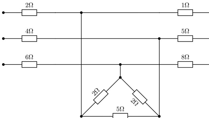
7. Calcular las corrientes de línea del circuito trifásico no equilibrado siguiente:
