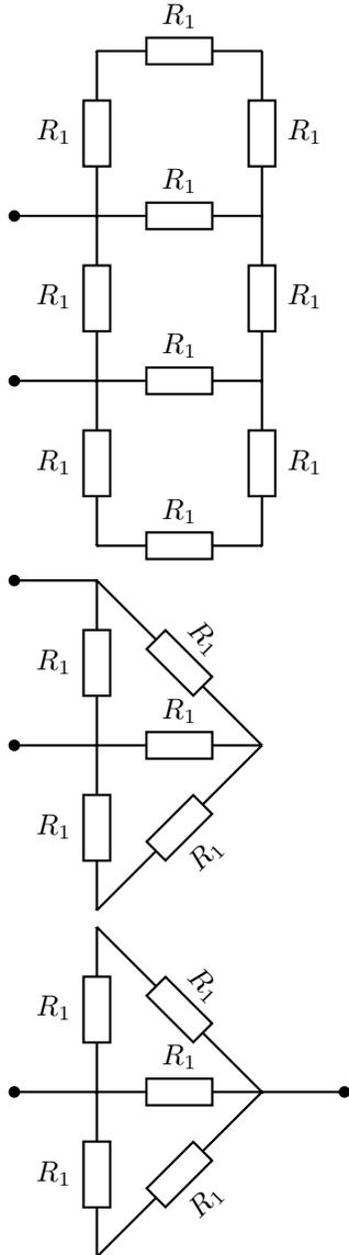
10. Calcular la resistencia equivalente vista desde los dos puertos dibujados en función de  $R_1$
