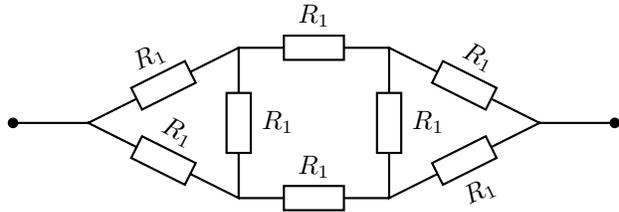
14. Calcular la resistencia equivalente vista desde los dos puertos dibujados en función de  $R_1$
