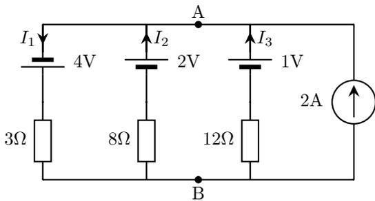
7. Calcular la diferencia de potencial entre los nodos A y B y las corrientes marcadas (usar el teorema de Millman)
