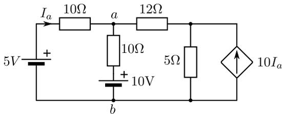
16. Calcular el equivalente Norton del circuito de la Figura 16 entre los puntos  $a$  y  $b$ .
