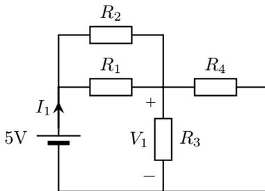
2. Calcular la corriente  $I_1$  y el voltaje  $V_1$ .
