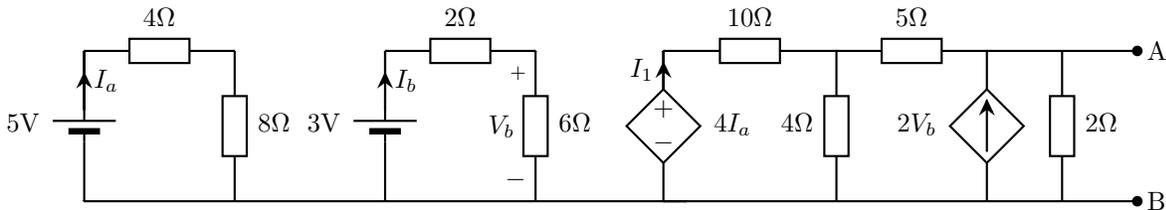
19. Calcular el equivalente Norton del circuito de la Figura 19 entre los puntos  $a$  y  $b$ .
