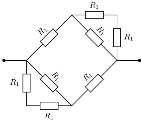
13. Calcular la resistencia equivalente vista desde los dos puertos dibujados en función de  $R_1$
