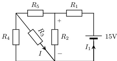
3. Calcular las corrientes  $I_1$ ,  $I$  y la diferencia de potencial de la resistencia  $R_2$ .
