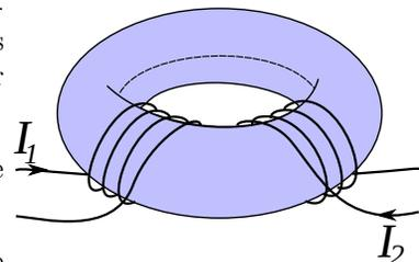
5. Este problema trata varios aspectos de los circuitos magnéticos. En el circuito magnético de la figura se establece un flujo de campo magnético mediante la bobina. Se ha realizado un corte en el circuito magnético llamado entrehierro. El material ferromagnético es hierro fundido, consideramos el material lineal con una permeabilidad relativa  $\mu_r = 1000$  S.I. La bobina tiene 800 espiras enrolladas alrededor de la columna central.
