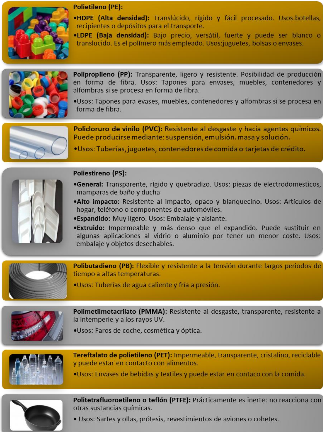
Figura 3. Esquema de las propiedades y usos de los principales termoplásticos [Elaboración propia].
