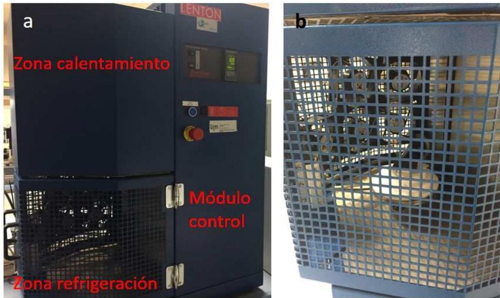
Figura 2.4 Imagen del horno Lenton utilizado para la realización de los ensayos de choque térmicos y b) detalle del montaje en la zona de enfriamiento, con el soporte de la muestra y los ventiladores.
