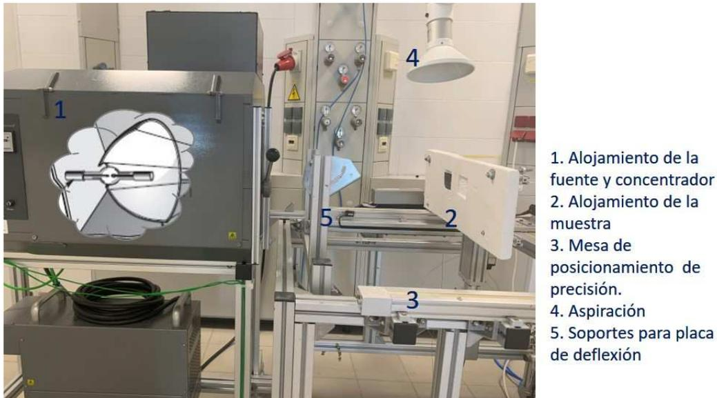
Figura 2. 6 Simulador solar Kiran con los distintos componentes enumerados.
