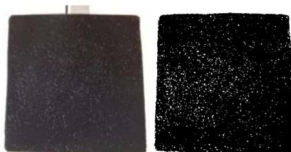
Figura 3. 14 Ejemplo de muestra tratada a 750 °C durante 24h. A la izquierda se ve la probeta extraída del horno y a la derecha la imagen tratada para cuantificar el área recubierta y el área de sustrato.
