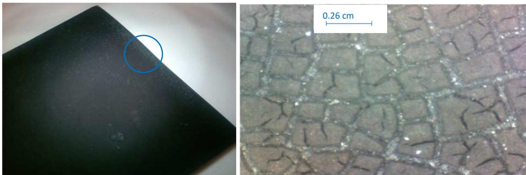
Figura 3. 20 a) Superficie de la pintura después de 200 ciclos (T max de 750 °C y T min de 300 °C con velocidades de enfriamiento y calentamiento 50 °C/min. b) Detalle.
