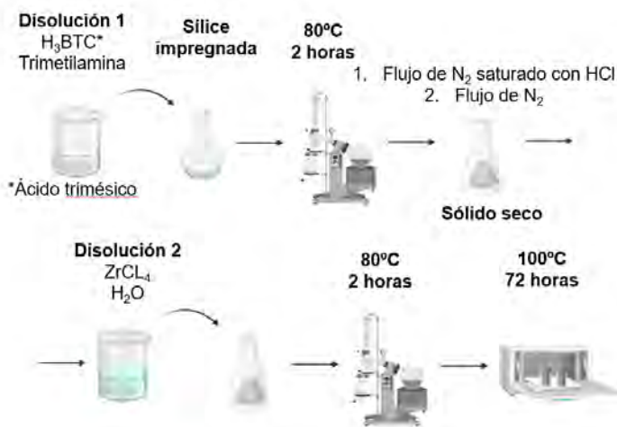
Figura 3.11. Procedimiento de síntesis de los materiales híbridos de MOF-808(Zr) soportado sobre materiales síliceos.
