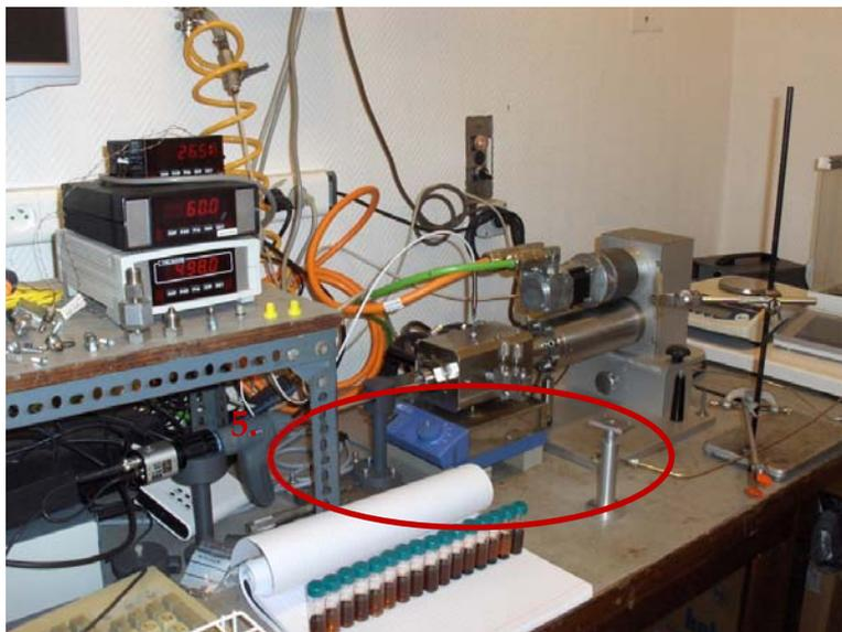
Figura X.3. Sistema de presurización del filtro en la celda PVT para filtrar en condiciones isoterma e isóbaras.
