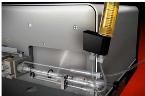
Figura I.7. Esquema del interior del viscosímetro SVM 3000.
