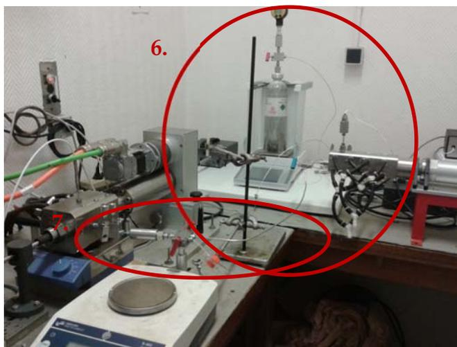
Figura X.4. Detalle de las conexiones del sistema de filtrado.
