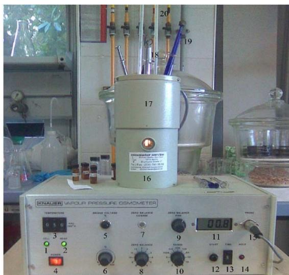
Figura I.6. Osmómetro de presión de vapor *Knauer Type 11.00*.
