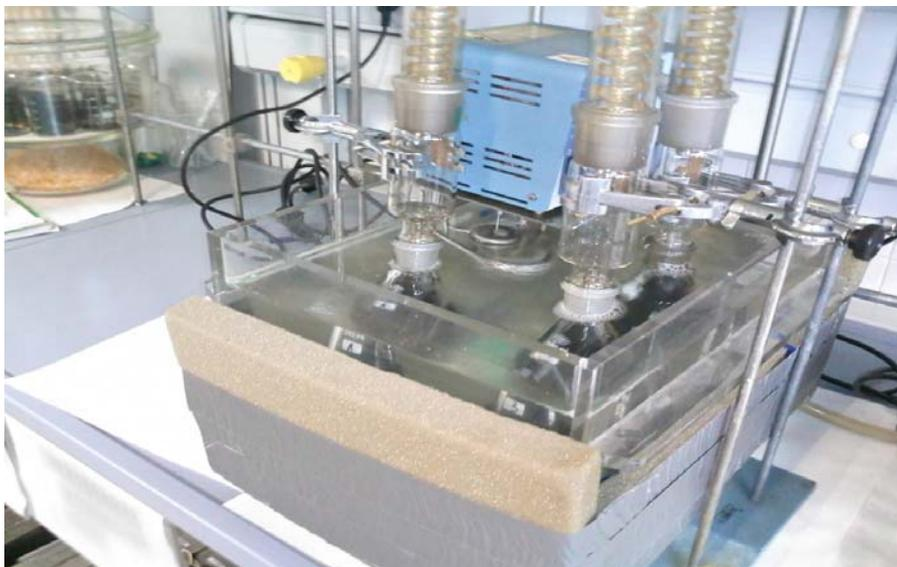
Figura III.2. Fotografía de la instalación experimental para la realización o la precipitación a temperaturas diferentes a la de ebullición del n-alcano precipitante.
