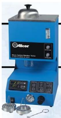
Figura I.8. Equipo para la determinación del residuo carbonoso según la norma ASTM D-4530.
