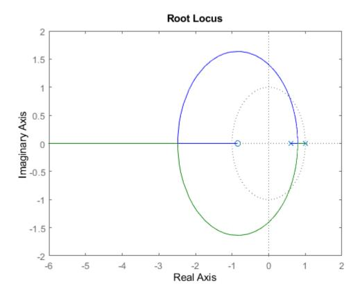
c) Obtener la ganancia crítica con una precisión tal que permita obtener una respuesta claramente oscilatoria durante 10 segundos cuando G se realimenta negativa y unitariamente
