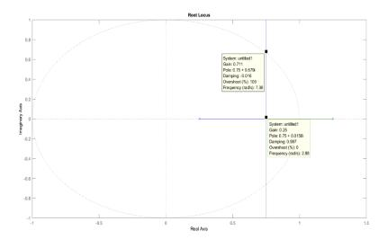
Por la estructura del LDR, básicamente sus asíntotas, nunca se podrán obtener polos con parte real z=0.25 (objetivo). Por tanto, se requiere implementar un controlador más avanzado que un simple regulador proporcional. Se prueba, inicialmente, con un controlador PD:  $R(z)=K(z^{-a}/z)$ . Se tienen dos incógnitas, por lo que, a partir del criterio de fase
