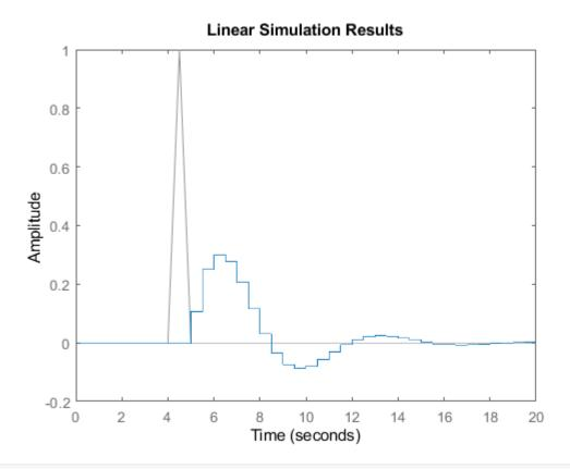
b) Obtener la respuesta en lazo cerrado cuando G, una vez discretizada, se integra en un sistema con realimentación negativa y unitaria, cuya secuencia de entrada es una función impulso retrasada 10 muestras.
