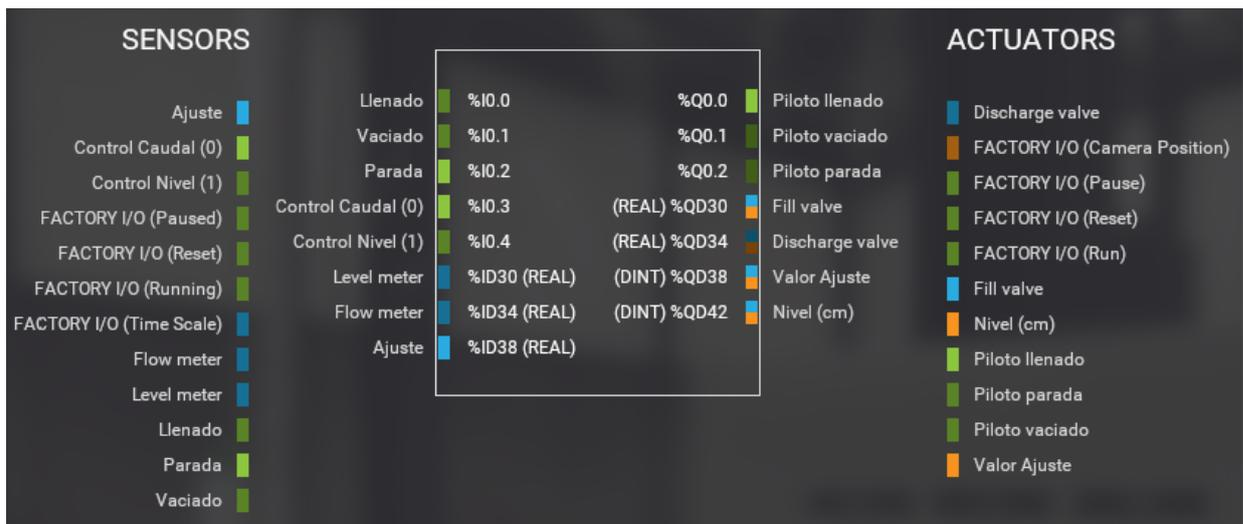
Figura 21. Configuración del driver de conexión con PLCSIM
