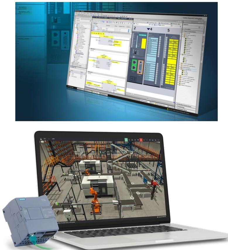
Figura 1. Herramientas software SIEMENS TIA Portal v15.1 (arriba) y Factory I/O (abajo).
