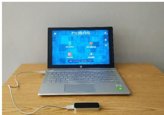
Figura 12. Leap Motion Controller<sup>®</sup> y ordenador portátil empleados durante el periodo de realidad virtual
