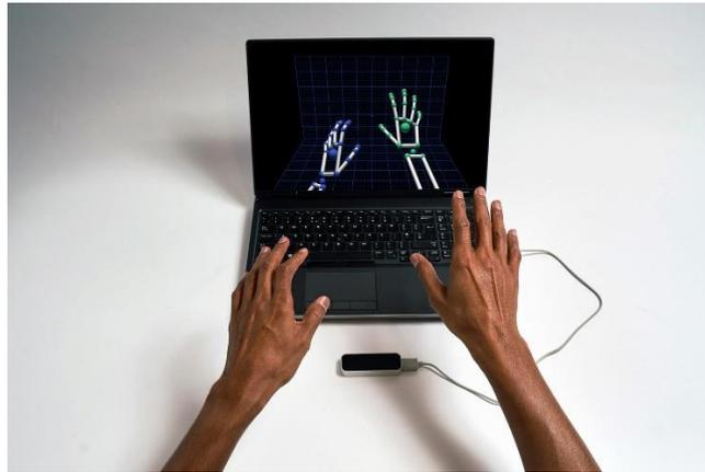
Figura 6. Dispositivo Leap Motion Controller®. Fuente: Ultraleap (150)
