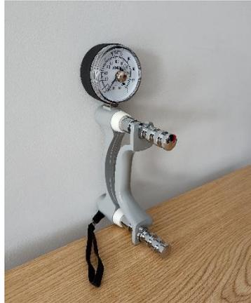
Figura 16. Dinamómetro hidráulico Jamar®
