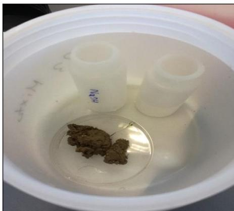
placa con suelo para la respiración y Esquema para la valoración acido-base de la NaOH.
