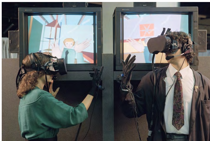
Figura 15. Dispositivos EyePhone y DataGlove de la empresa VPL. Fuente: Facultad de Arquitectura, Diseño y Urbanismo de la Universidad de Buenos Aires (2022).
