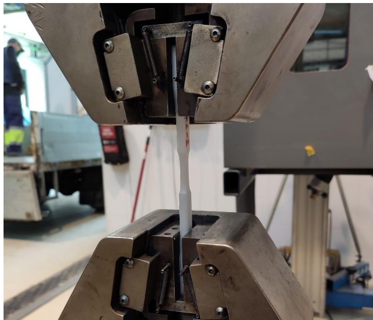
Figura 19 Fenómeno de estricción previo a la rotura de la probeta
