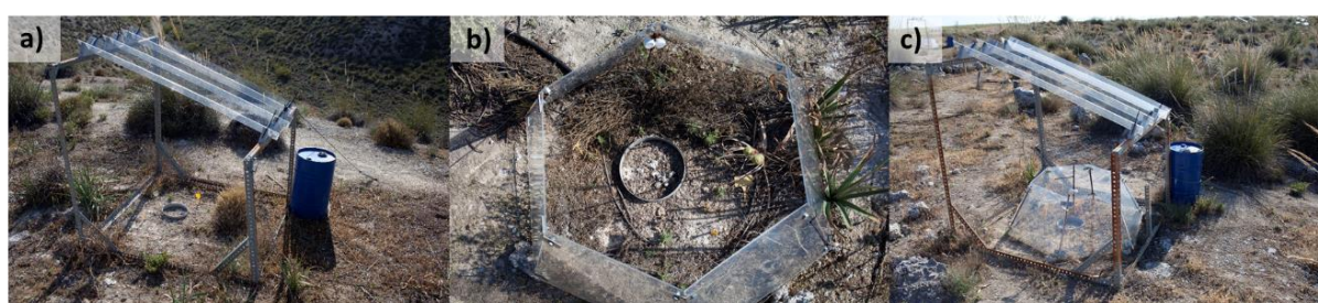
Figura 8. Fotos del detalle del tratamiento manipulativo de cambio climático llevado a cabo en Aranjuez. a) Caseta para la reducción de la precipitación; b) cámara de techo abierto (OTC) para simular el calentamiento; c) combinación de los tratamientos de reducción de la precipitación y calentamiento. Los anillos de PVC contienen la costra biológica del suelo. Fotografías de Concha Cano Díaz y Felipe Gutiérrez.
