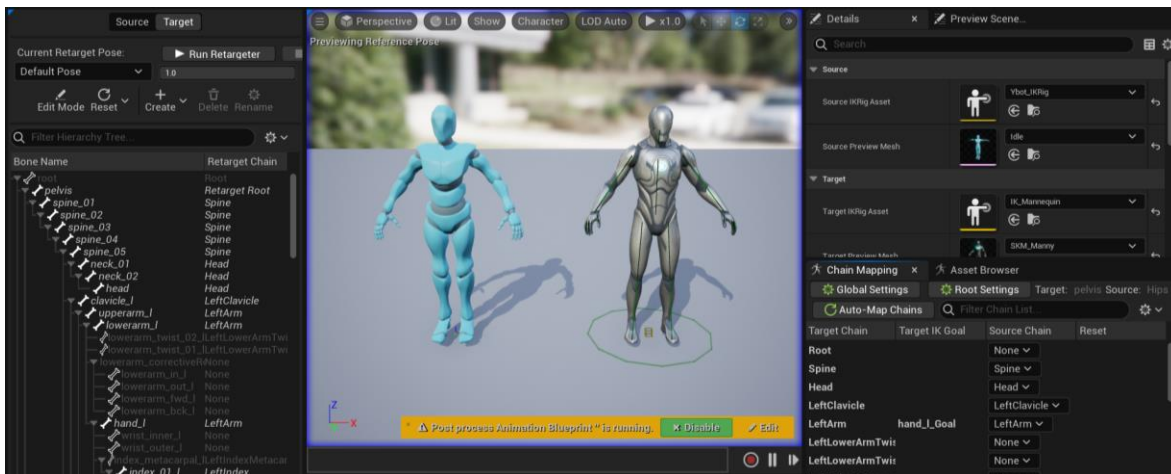
Figura 60 Traducción de movimientos entre dos sistemas de huesos distintos con IK Retargeter de Unreal Engine 5.
