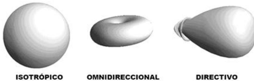
Figura 3.3: Clasificación según el diagrama de radiación [3]
