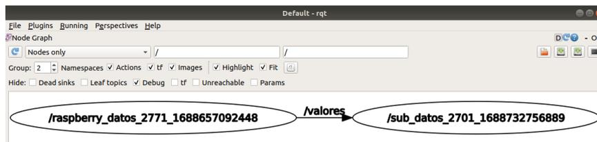
Figura 5.1: Resultado de la integración en ROS del bloque de monitorización de parámetros.
