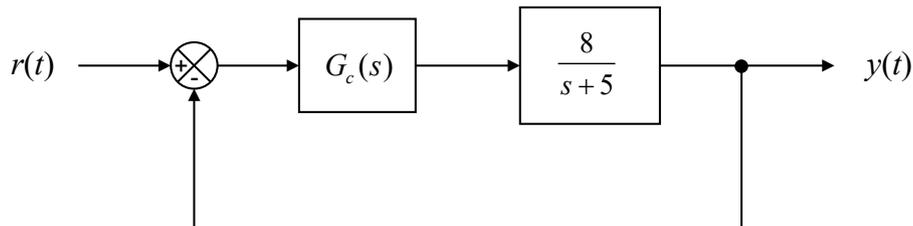
**Ejercicio práctico 5:** Utiliza la herramienta RLTOOL para averiguar el controlador más sencillo de tipo PID (P, PI, PD ó PID) a colocar en el sistema de la figura de forma que dicho sistema tenga ahora  $M_p = 20\%$  y  $t_s(2\%) = 1$  s.
