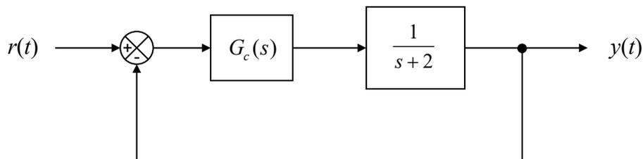
**Ejercicio práctico 4:** Utiliza la herramienta RLTOOL para averiguar el controlador más sencillo de tipo PID (P, PI, PD ó PID) a colocar en el sistema de la figura de forma que dicho sistema tenga una sobreelongación del  $M_p = 10\%$  y un tiempo de asentamiento  $t_s = 1$  s (para la banda del 2%)
