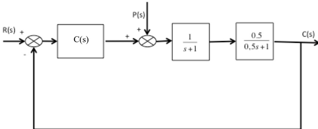
El controlador  $C(S)$  del sistema puede ser P, PI o PID. Se han obtenido por métodos empíricos los siguientes parámetros de tres controladores tipo PID:
