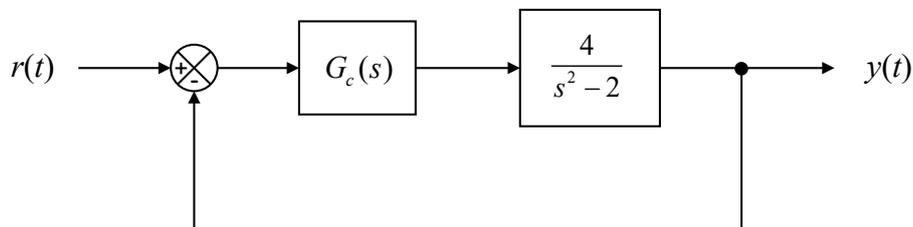
**Ejercicio práctico 6:** Utiliza la herramienta RLTOOL para averiguar el controlador más sencillo de tipo PID (P, PI, PD ó PID) que es necesario incorporar como controlador en el sistema para el control de la velocidad de la máquina herramienta del ejercicio de la práctica del tema anterior, "Lugar de las Raíces".
