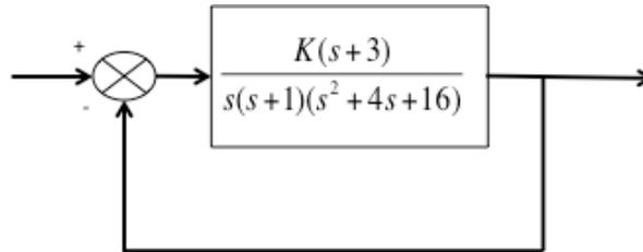
1. Encuentra gráficamente la posición de todos los polos en lazo cerrado del sistema para el límite de la estabilidad (sistema oscilante o no amortiguado).
