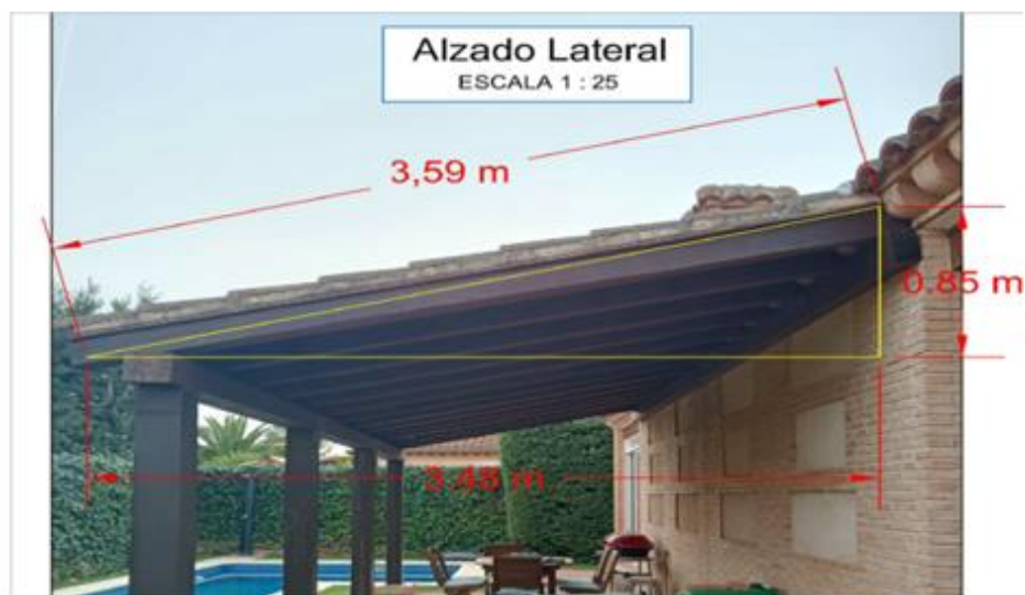
Figura 7. Alzado lateral del porche donde se muestra la inclinación.
