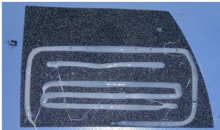
Figura 21. Impresión EPS con diámetro de aguja 16 G
