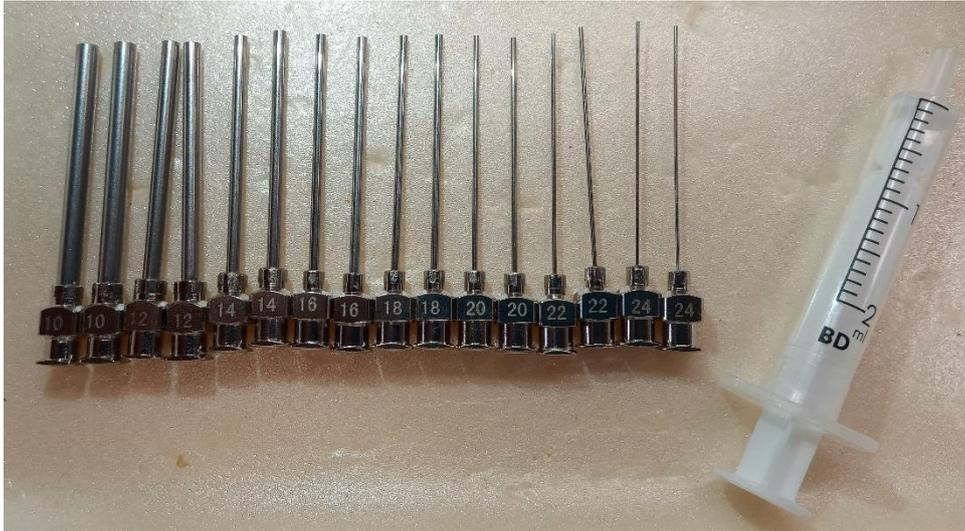
Figura 9. Jeringas de acero inoxidable con diferentes diámetros
