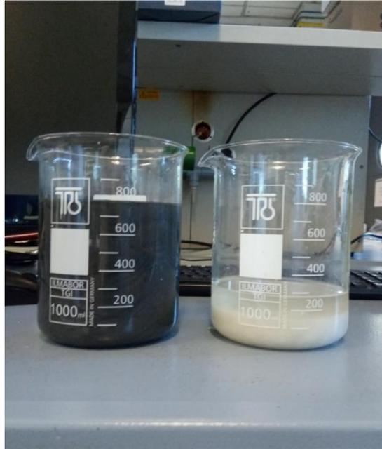
Figura 15. Disoluciones de las bandejas con y sin aditivos en acetona
