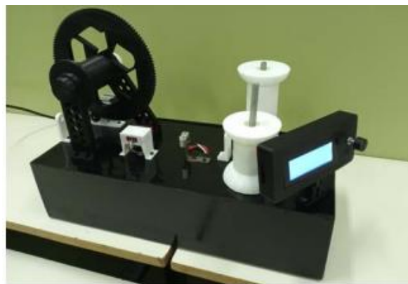
Imagen 34. Máquina generadora de filamento reciclado de PET [29].
