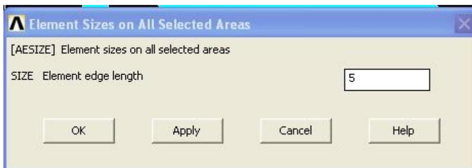
Figura 13: Definición del tamaño de elemento de la malla.
