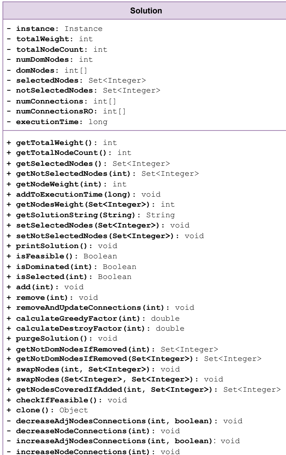
Figura 4.6: Diagrama UML de las clases principales no relacionadas (II). Clase Solution
