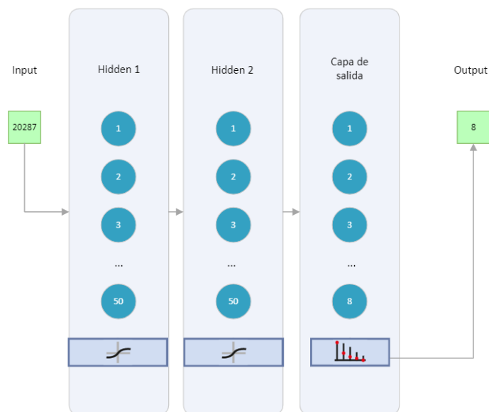
Figura 22. Diagrama de la arquitectura de la red neuronal inicial con 2 capas ocultas (experimento P1)
