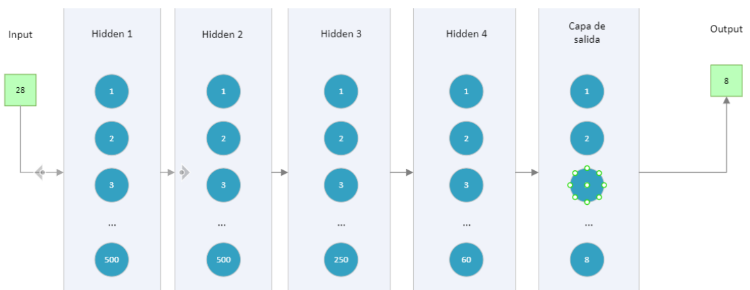
Figura 24. Diagrama de la arquitectura de la red neuronal (experimentos P3-P6), con matriz de características como entrada.
