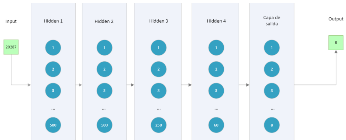
Figura 23. Diagrama de la arquitectura de la red neuronal (experimento P2), con audios en bruto como entrada
