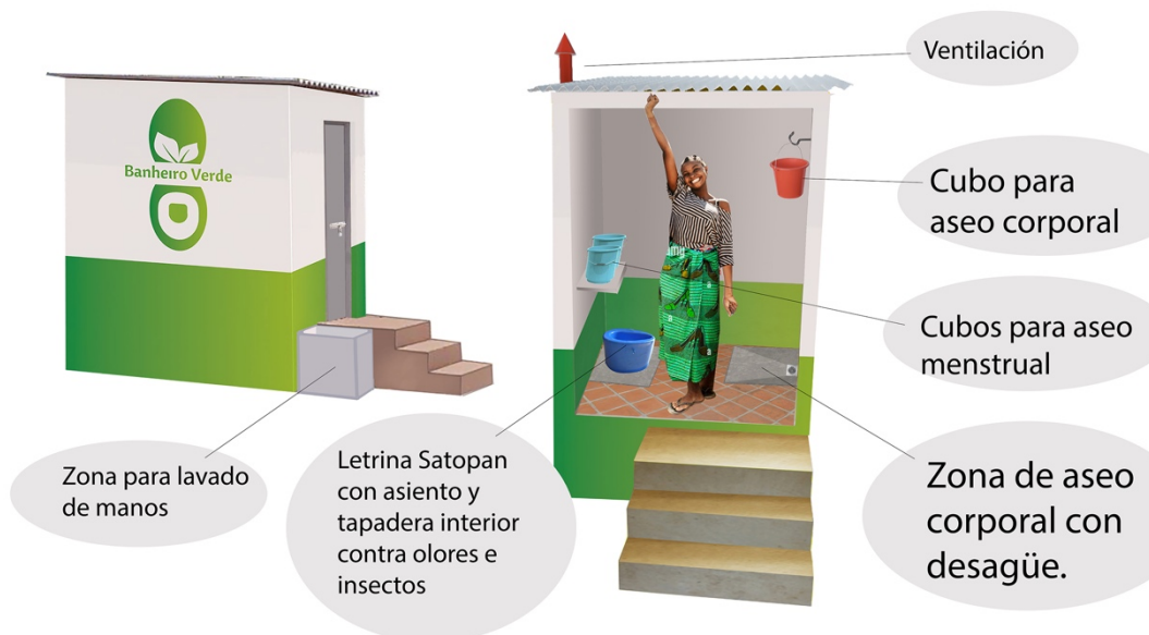
Gráfico 07: Propuesta de distribución y características de los elementos de la letrina | Elaboración propia para el equipo de CCM Worldwide
