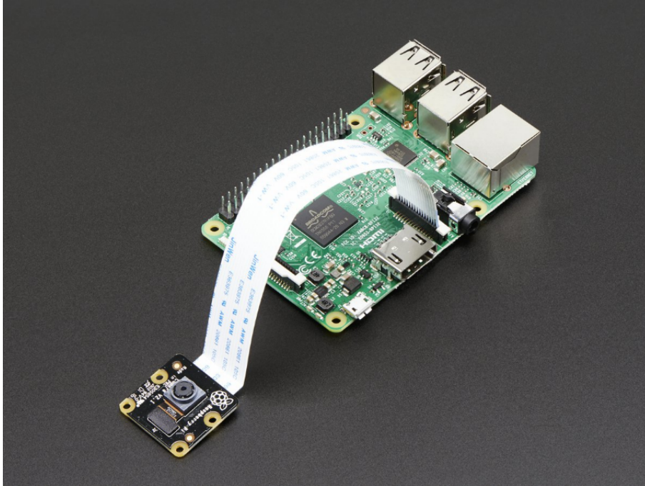
Figura 3.16: Módulo de cámara conectado al OBC. Imagen de [16]
