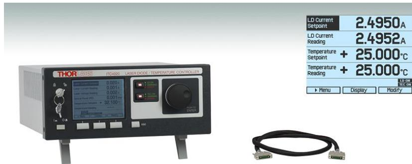
Figura 2.30: Controlador láser comercial [57]
