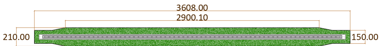
Figura 18. Franja añadida a la pista de la misión [Elaboración propia en AutoCAD]
