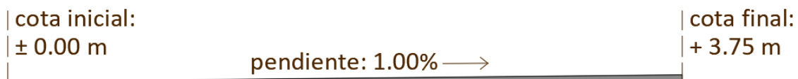
Figura 53. Pendiente de las calles de rodaje de la misión [Elaboración propia en AutoCAD]
