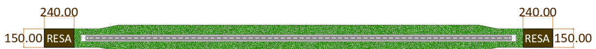
Figura 19. RESA añadida a la pista de la misión [Elaboración propia en AutoCAD]
