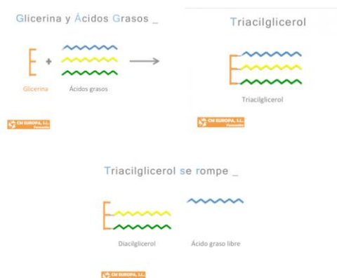
Ilustración 3 - Esquema del proceso de generación de un ácido graso libre [15]
