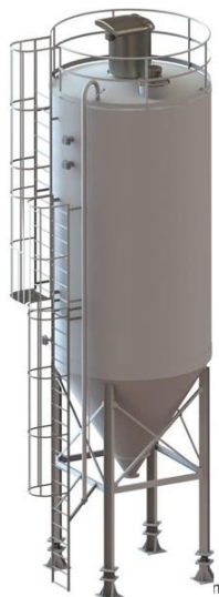
Ilustración 29 - Silo de cal
