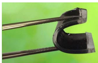
Ilustración 19. Supercondensador autorreparable doblado en forma de U con unas tenacillas. En el momento de ser soltado, recuperará su forma original. (Foto: University of Surrey). 71
