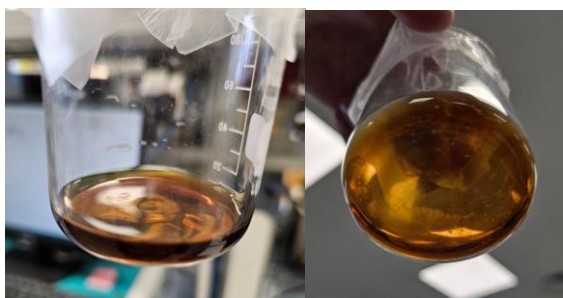
Ilustración 33 Muestra DZ02 después de haber sido enfriada de nuevo y sobrehidratada.
