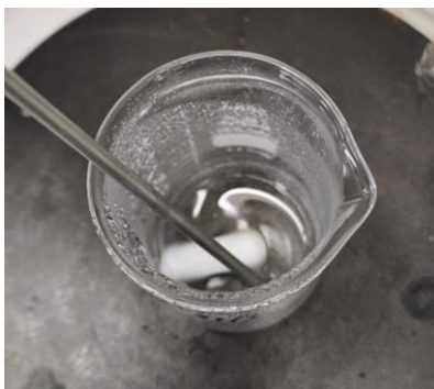
Ilustración 26. PVA diluido con agua destilada en el proceso de agitación y calentamiento antes de ser vertido al compuesto.
