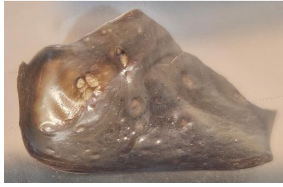
Ilustración 29. Muestra DZ06 después de haber sido deshidratada y fracturada.
