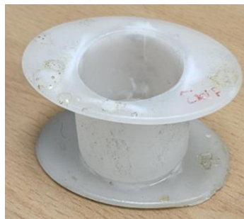
Ilustración 30. Recipiente montado, lubricado y preparado para contener la resina mientras se solidifica y la muestra DZ06.
