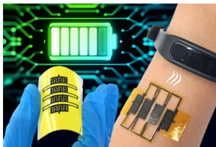
Ilustración 15. Sistema autoalimentado y extensible que podría utilizarse en el futuro en dispositivos portátiles para el diagnóstico de la salud y la monitorización, recolectando energía de la respiración y el movimiento humanos. 55
