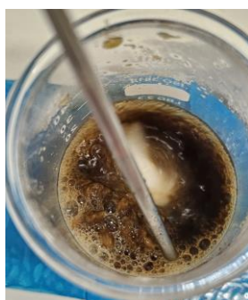
Ilustración 27. Muestra DZ06 en el proceso de agitación y calentamiento. Es posible observar una pequeña masa formada abajo a la izquierda de la imagen, que se corresponde con la mezcla de las dos disoluciones tras haber pasado poco tiempo después de haberse juntado.
