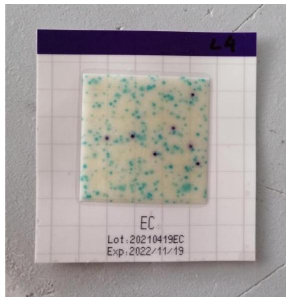
*Figura 11: Resultado obtenido con el medio MC-Media Pad de la muestra de agua L4 recogida en la cuenca hidrográfica de Lancetilla (quebrada Las Moncadas, fig. 2), el 13-07-2022. El color azul-verde/azul muestra las unidades formadoras de colonias de coliformes totales (220 UFC/ml) y el color morado las de *E. coli* (7 UFC/ml).*
