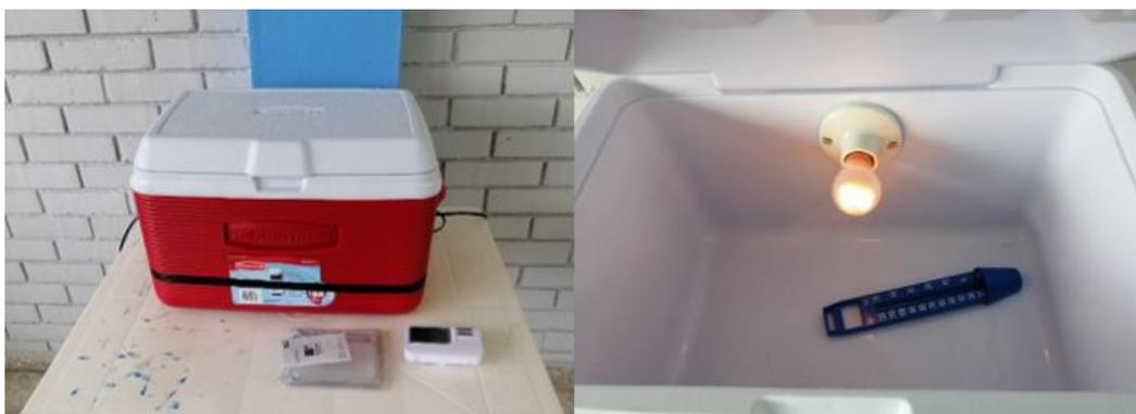
*Figura 10: Se muestra la mini nevera convertida en estufa con bombilla regulable y termómetro en su interior, vista externa e interna (Tomada en la zona de trabajo de la UNAH, 2022).*
