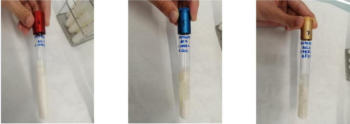
*Figura 6: se muestran los resultados obtenidos de una muestra de agua contaminada con E. coli tras 24 h. De izquierda a derecha: control de leche CL1 (100%L), control de leche inoculado con E. coli CL5 (100%L + E. coli) y muestra de leche y muestra de leche con agua contaminada ML7 (75%L-25%AC). Tanto CL5 como ML7 muestran coagulación, lo que indica presencia de E. coli. Tomadas en el Laboratorio URJC (experimento 56, 27-06-2022).*
