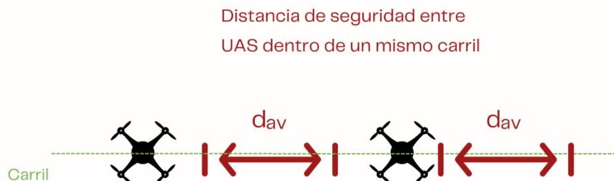
Ilustración 48.- Declaración de distancia de seguridad entre dos sUAS dentro de un mismo carril en la dirección de avance, elaboración propia
