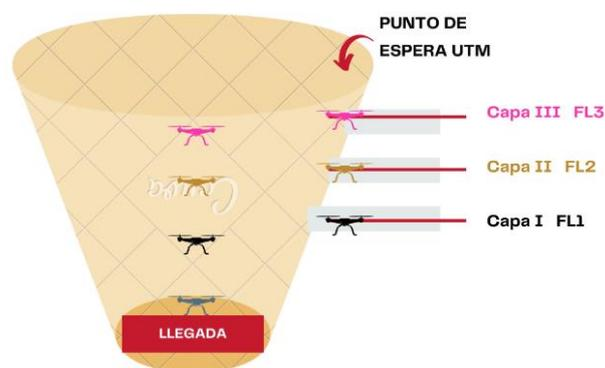
Ilustración 24.- Vista en alzado del aterrizaje de un sUAS, elaboración propia
