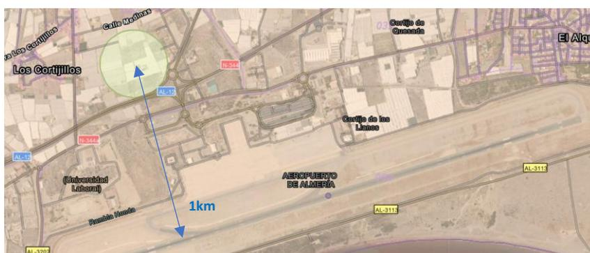
Ilustración 37.- Localización lateral del vertipuerto con respecto a los ejes de pista, elaboración propia
