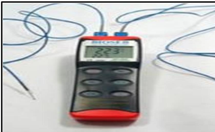
**Figura 26:** *Termómetro de investigación de contacto superficial (foto con material y elaboración realizada para la Tesis)*
