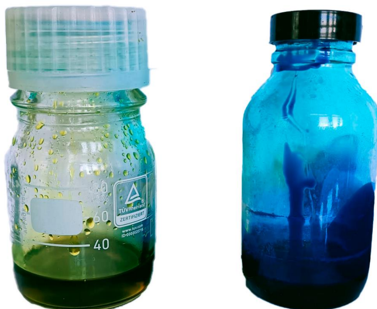
Figura 5.66. A la izquierda de color amarillo el líquido iónico sintetizado [P_{6,6,6,14}][FeCl_4] , y a la derecha de color azul el líquido iónico sintetizado [P_{6,6,6,14}]_2[CoCl_4] .
