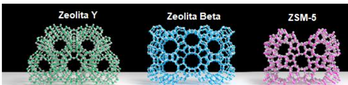
Figura II.22. Estructura de algunas de las principales zeolitas existentes (adaptado de [100]).
